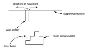
A figura acima mostra um diagrama esquemático de um equipamento para esculpir, com laser, um bloco de material maciço. Na figura vemos um emissor laser que se desloca horizontalmente para a direita e para a esquerda com velocidade constante. Quando o emissor é ligado durante o deslocamento, uma camada de espessura constante é removida do bloco, sendo vaporizada pelo laser.
